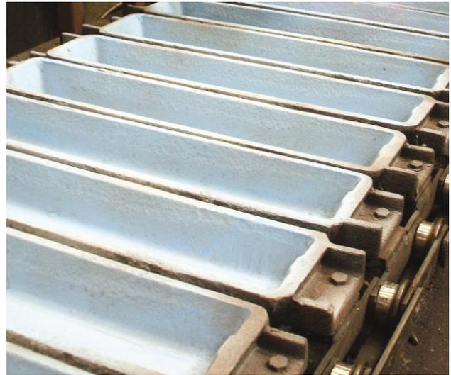
metal fundido, todos os revestimentos Nanocomp Met Cast tem a propriedade, em baixas temperaturas, de se sintetizar em um revestimento cerâmico de alta temperatura.
